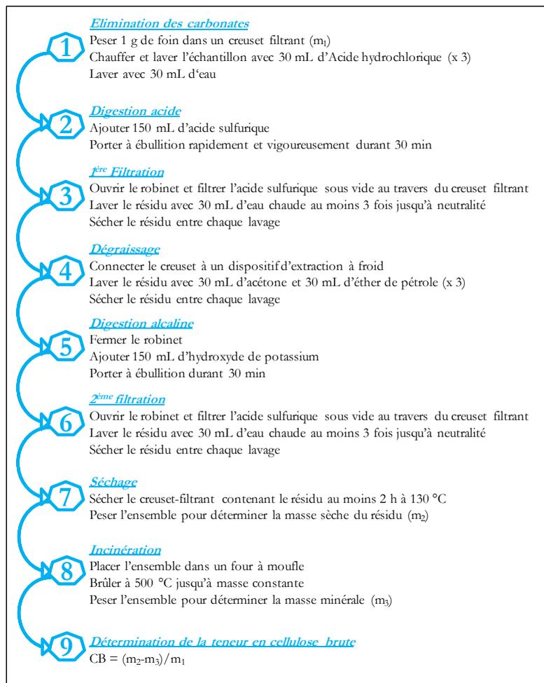
**Figure 50** : Protocole de dosage de la cellulose brute selon la méthode de Weende (Norme AFNOR, EN ISO 6865).
