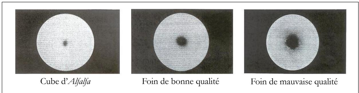
**Figure 7 :** Photographies de 3 filtres issus d'un prélèvement d'air dans la zone de respiration du cheval nourrit avec 3 foin différents : a) un cube d'*Alfalfa* (luzerne), b) du foin qualifié de bonne qualité et c) un foin qualifié de mauvaise qualité. (D'après Raymond *et al.*, 1994).
